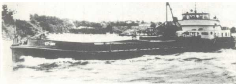
Рис. 8. Грузовой теплоход грузоподъемностью 350–400 т проекта 912А
